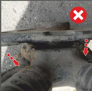
Применение сварки, механической обработки с целью ремонта или доработки узла
